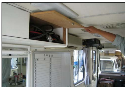
図3 外部電源ケーブル収納場所
