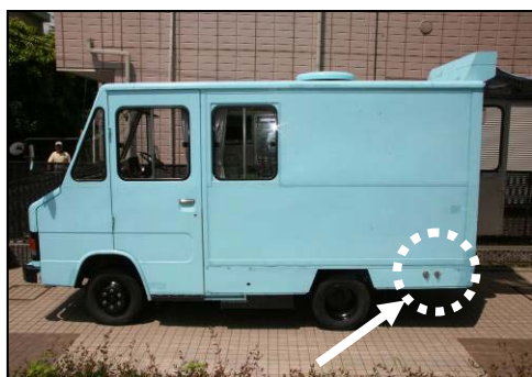
外部電源位置
